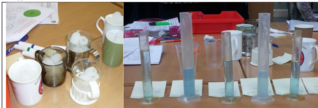
Провера изолаторских карактеристика шоља топљењем леда
