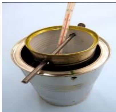
Figure 5.4: Мерење температуре воде у калориметру.
